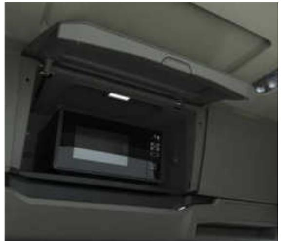
**Mikrowellenherd mit integrierter 24-V-Stromversorgung**
