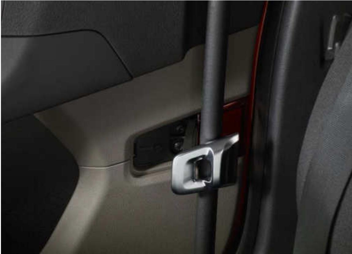
**Nachtverschluss - mechanisches Sicherheitstürschloss für die Baureihe NTG**
