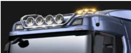
**Scheinwerferbügelsatz, lange Ausführung, mit LED für normales Dach und inkl. 4 Scheinwerfer Hella Luminator**
