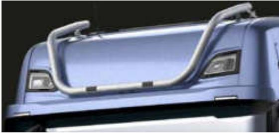
**Dachlichtgruppen-Satz, Ausführung Airflow für hohes Dach**
