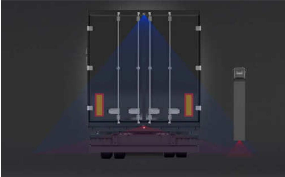
Rückfahrkamera Famos (Sattelzugmaschine) Konfigurationszeichnung
