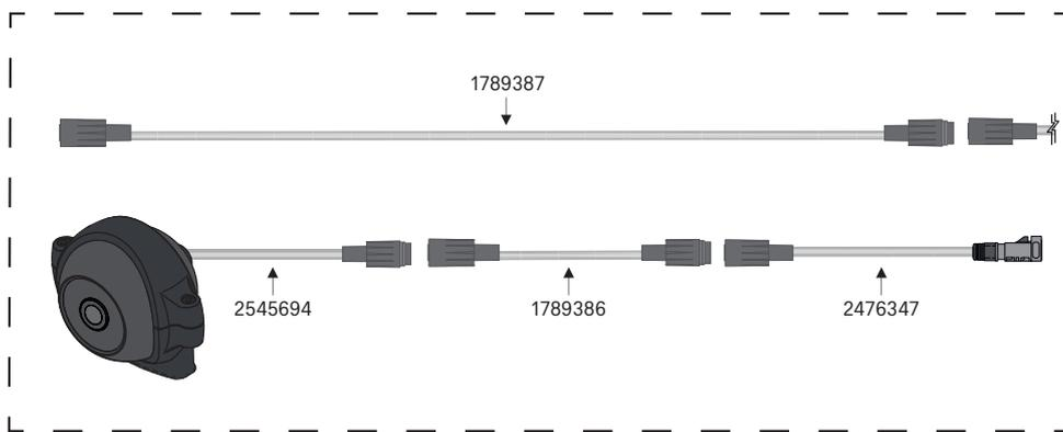
3. Konfiguration für Fahrgestell (mit mehreren Kameras, bis zu 8)
