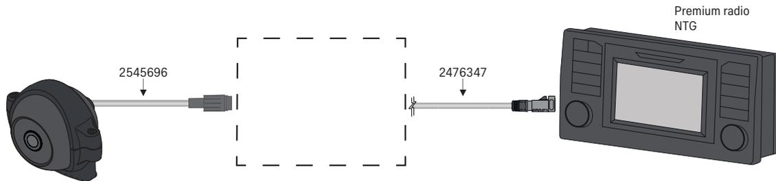
1. Konfiguration für Fahrgestell (nur Rückfahrkamera)
