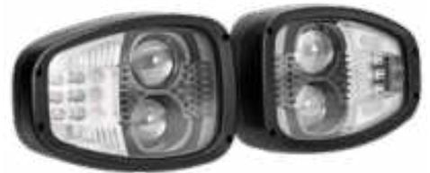
**ABL NBB Schneepflug-Scheinwerfer Voll-LED**, mit integrierten Blinkern und Positionslicht. 164x240 mm. 22 W Fernlicht und 32 W Abblendlicht. Schwarzes Kunststoffgehäuse mit Halter in hinterer Position. Gehärtetes klares Leuchtenglas. Eingebauter 6-poliger DT-Steckverbinder. 24 V, mit eingebauten Widerständen, Thermomanagement und Verpolungsschutz. Schutzart: IP68 – IP69K. EMC CISPR25 Klasse 3. ECE: R112, R6, R7 L- und R-Einheiten separat erhältlich.
